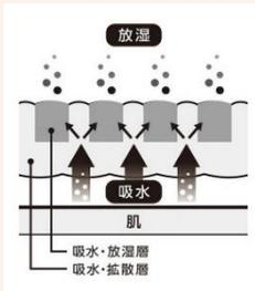
「トップバリュ ピースフィット 極さら」シリーズの生地は、肌側と表側が異なる特殊な編み方をした独自のダイヤモンドリブ®※<sup>4</sup>構造により、汗によるマスクと肌との不快なベタつきを軽減し、いつもさらっとした肌ざわりを実現しています。
