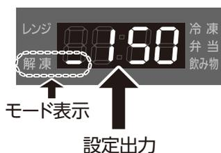
表示部の解凍の横に「」表示され、出力W数の150が表示されます。
