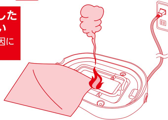
**●通電したヒーターに可燃物が触れると、火災の原因になります。必ずプレートをセットしてから通電してください。**
